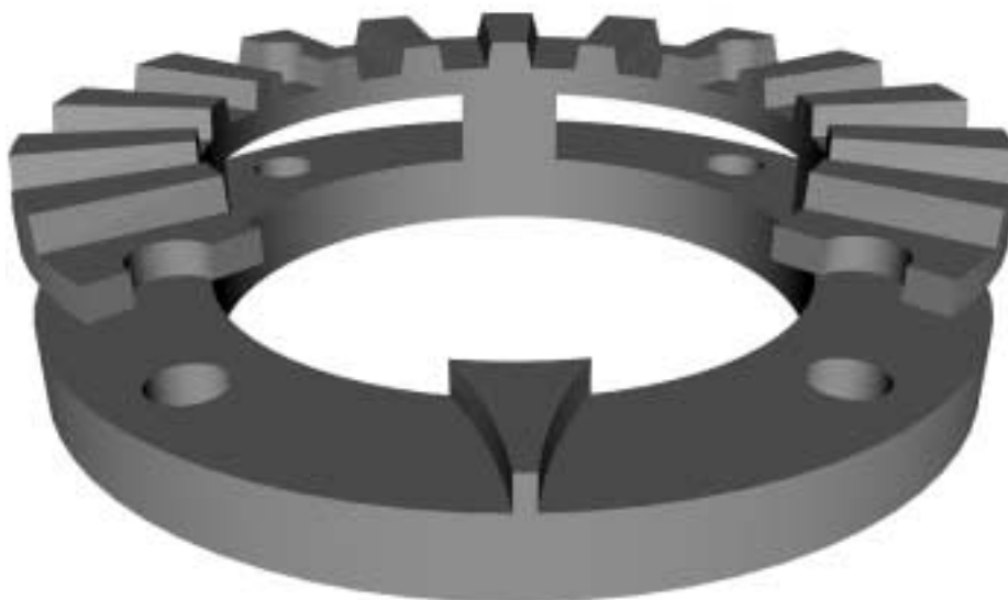
Рис.3.23 – Правая полумуфта резцедержателя, используемая в качестве упругого элемента датчика
