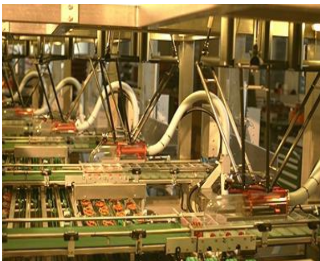
Рисунок 1 - Автоматична лінія для упаковки кондитерських виробів
